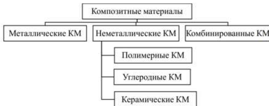
Рис.1. Уточненная классификация композитных материалов по природе компонентов.
