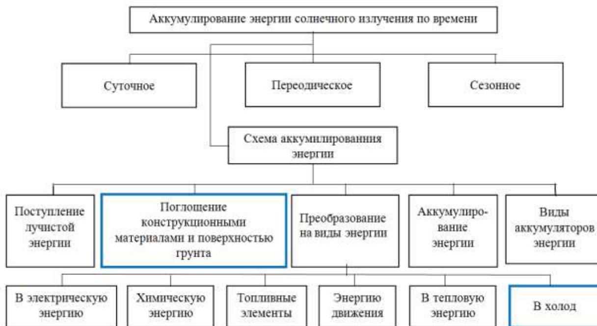
Рис.1. Схема аккумулирования солнечной энергии по времени в теплице.
