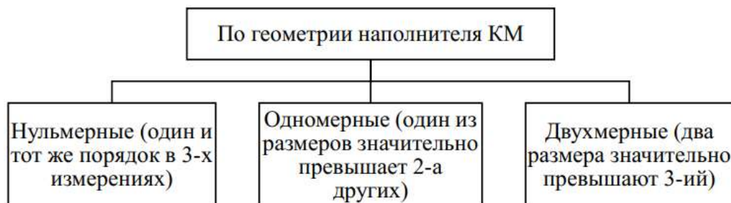
Рис.2. – Классификация композитных материалов по геометрии наполнителя.
