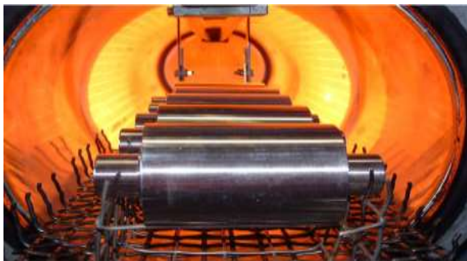
4-расм. Партиядаги деталларни термик ишлаш жараёни.
