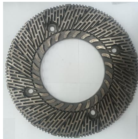
Рис.1. Кольцевая гарнитура с углом наклона ножей к радиусу с перегородками между ними.
