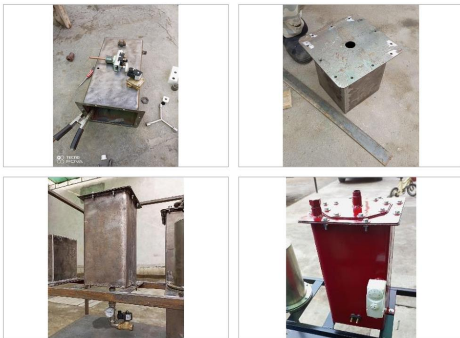
2-расм. Мой қиздириш қурилмасининг ясалиш ва ўрнатилиш жараёнлари.
