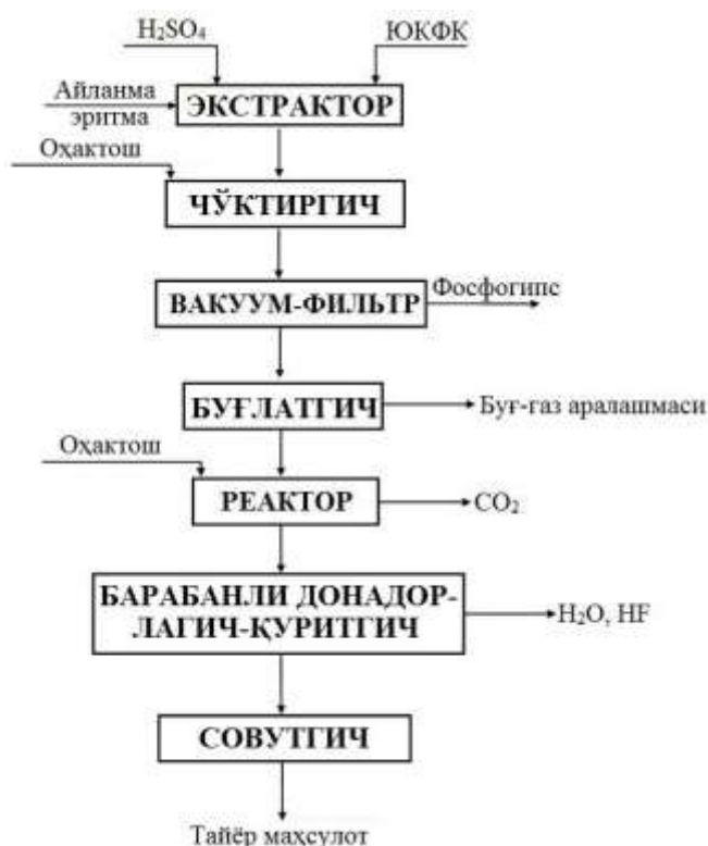
1-расм. Марказий Қизилқумнинг ювиб куйдирилган фосфатли концентратидан (ЮКФК) юқори сифатли фосфорли ўғит ишлаб чиқариш моддий оқим блок-схемаси.
