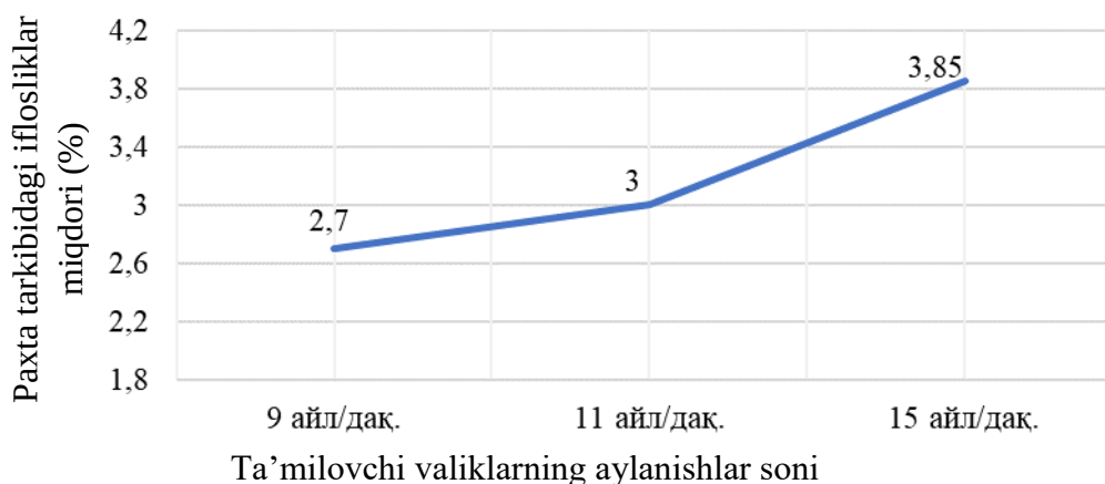
4-rasm. Takomillashtirilgan renerator ta'minlovchi valiklarining aylanish tezligini paxta tarkibidagi iflosliklar miqdoriga ta'siri.
