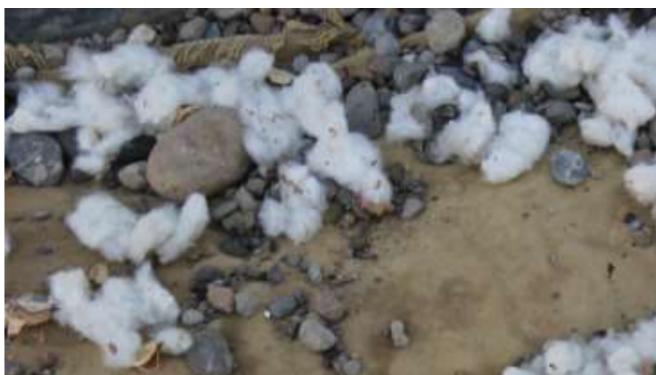
3-rasm. Ajralayotgan og'ir aralashmalar tarkibida paxta bo'laklarini o'tishi.
