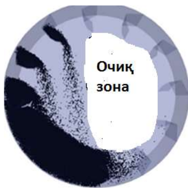
1 - расм. Г симон насадка билан жиҳозланган қуритгич юза кесимида очик ва ёпиқ зоналар схемаси ва барабан насадкаларининг кўриниши.
