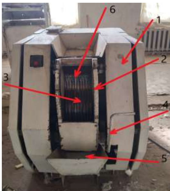
1 - korpus, 2 -Ishchi kamera, 3 – arrali slindr, 4 - rostlagich, 5 - chigit yig'uvchi, 6 – tarkibli kolosniklar. 1-rasm. DL-10 jin mashinasining tarkibli kolosnik o'rnatilgan ko'rinishi.
