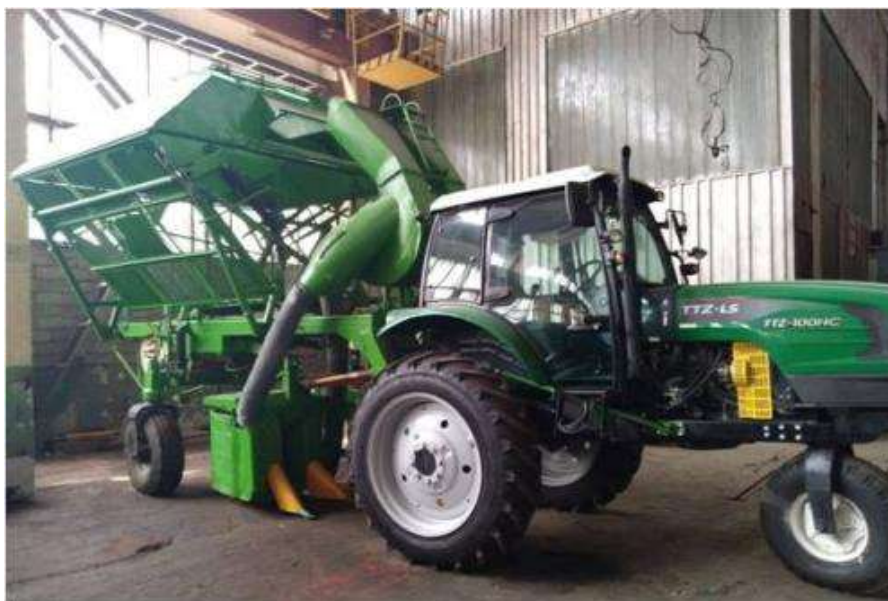
Рис.5. Хлопкоуборочная машина МХ-1,8 ГВ, оснащенная вертикально шпиндельным аппаратом с новой U-образной приемной камерой.
