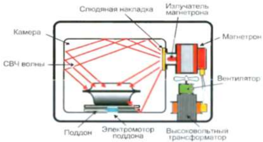
Рис. 1. Микроволновая печь в разобранно-схематичном виде.
