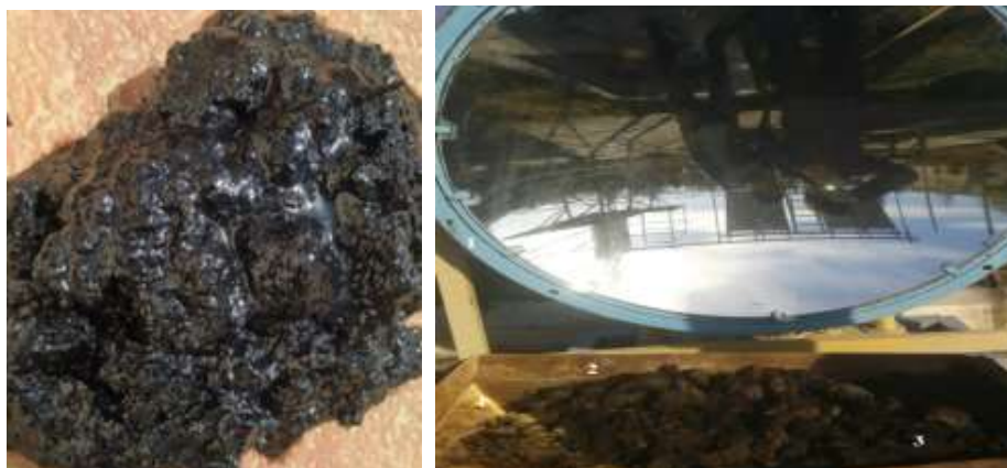
а) б) 2-расм. а) Майдон чўкмаси, б) Қўёш концентратори 1-концентратор, 2- мослама, 3- чўкинди.
