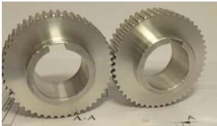
2-расм. Арра оралик қистирмаларини тайёрлаш учун шестерналар.
