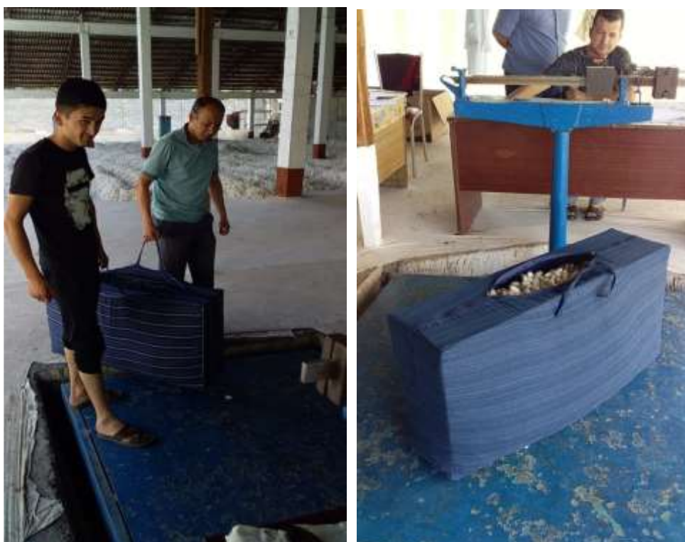
2-расм. Пилларни қабул қилиш, ташиш ва сақлаш учун янги мосламанинг умумий кўриниши ва ишлатилиш фрагментлари.
