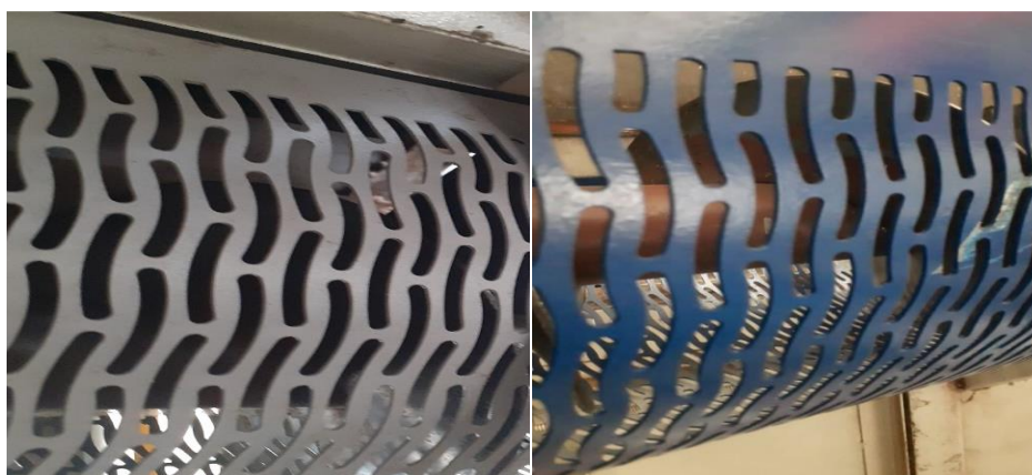
a – tarnovning ostki qismiga rezinali tayanchlarga o'rnatilgan 50x6, 45x4.5, 40x4 mm o'lchamli setkaning ko'rinishi.
