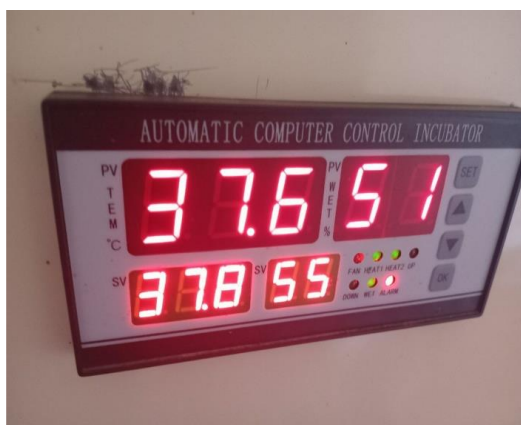
4-rasm. Kameradagi harorat va namlik datchigi.
