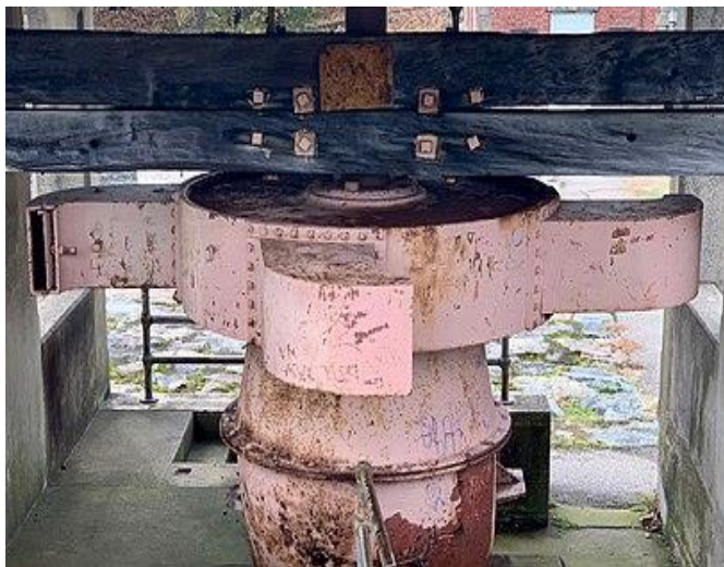
Рисунок 1. Сопло гидротурбины, установленное в государственном парке Хопатконг.
