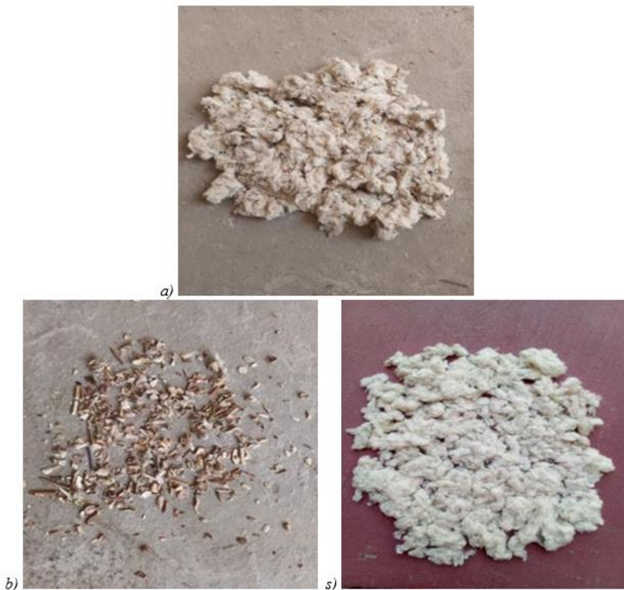
3.6-rasm. Ishlab chiqarishda lint va iflosliklar holati a) Tozalashdan oldingi lint xolati, b) Lint tarkibidagi mayda iflosliklar, s) tozalangan lint holati.
