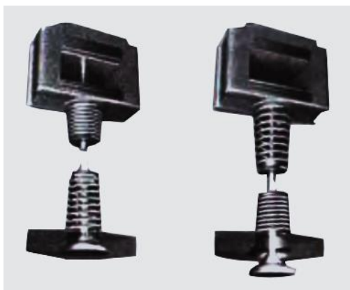
Рис. 1. Электромагнитный привод клапанов фирмы Renault.
