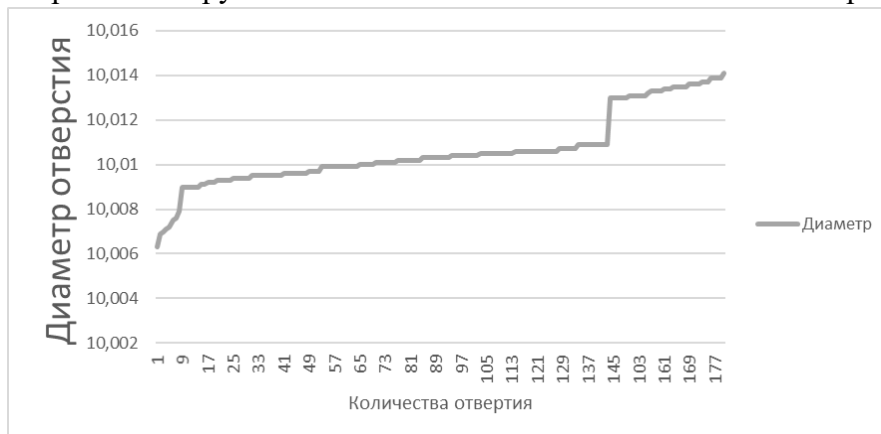
Рис. 4. Изменение формы отверстия по глубине сверления ( s=0.03 мм/мин; v=13.1 м/мин; l=150 мм).
