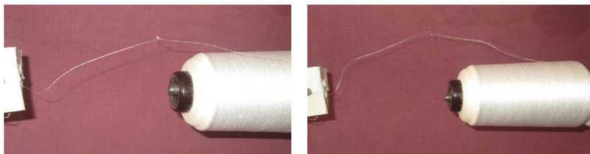
1-расм. 3,23×4текс табиий ипакни тандалашда тугунни баллон шаклига таъсири.
