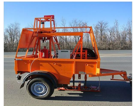
Рис. 1. Система измерения прочности дорожных одежд «Дина-3М»
