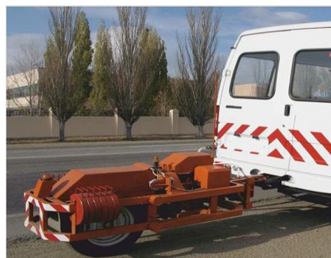
Рис. 6. Автомобильная установка ПКРС-2У для контроля ровности.
