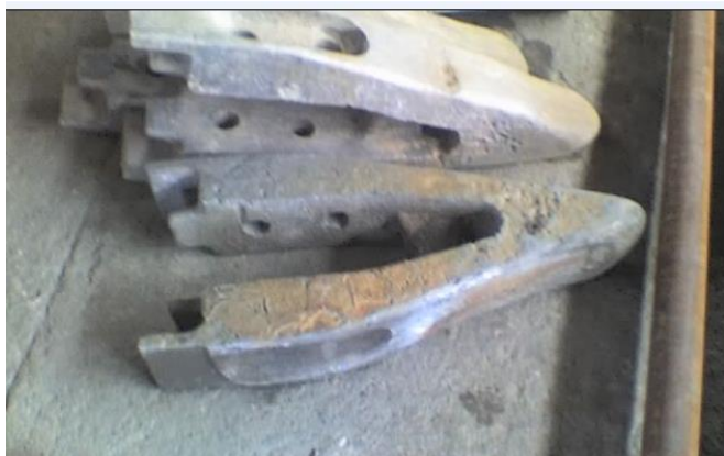
Рис.2. Зуб изношенный в режиме периодической переустановки.
