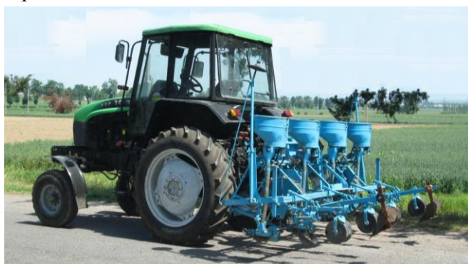
Рис.1. Трактор с регулируемым клиренсом в агрегате с сеялкой СЧХ-4Б.
