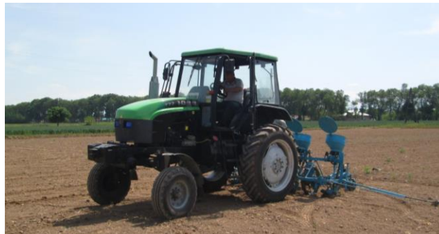
Рис.2. Посевной агрегат, состоящий из трактора с регулируемым клиренсом и сеялки СЧХ-4Б в работе.
