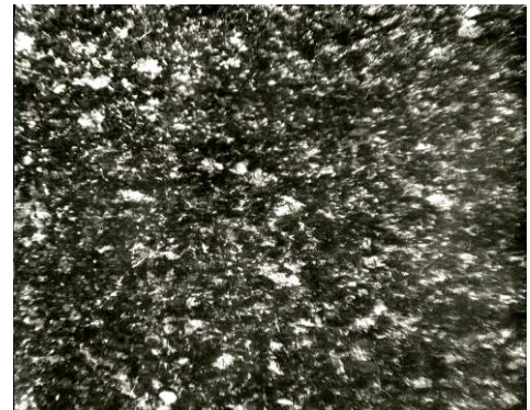
Рис. 6. Микроструктура основного металла на границе с ЗТВ. (светлые зерна – феррит, темные – перлит), \times 100 .
