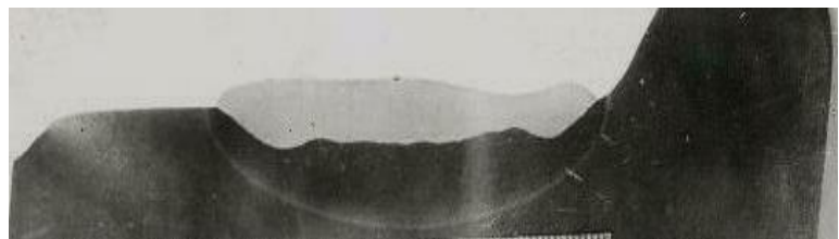
Рис. 2. Макроструктура наплавленного металла первого валика на поверхности катания колеса возле гребня.
