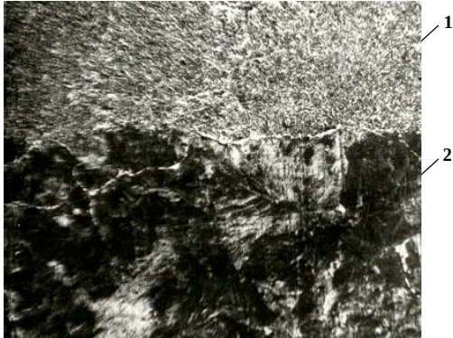
Рис.5. Структура наплавленного металла (1) и зоны термического влияния (2) (светлые зерна - феррит, темные – перлит), \times 100 .
