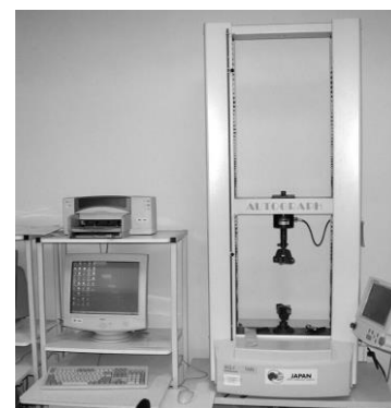
Рис.1 Прибор “AVTOGRAPH-AG 1” – предназначен для определения разрывных характеристик (разрывная нагрузка, разрывное удлинение) различных тканей.
