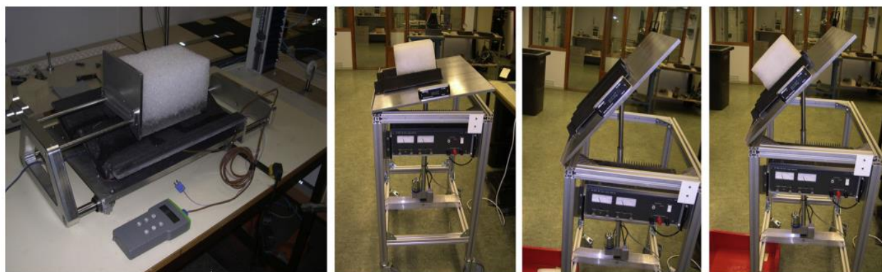
Рис. 3. Определение коэффициента трения между снегом и кровлей с использованием метода А — метод горизонтальной плоскости с приложением тяговой силы (первое фото слева) и метода В — метод наклонной плоскости (три фото справа).
