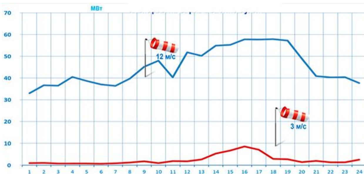
Рис1. Зависимость изменения нагрузки от скорости ветра в течение суток.
