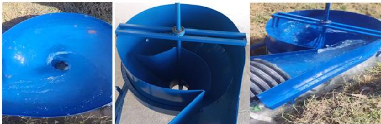
Rasm-5. Konussimon havzaning 45^\circ , havza diametrlarining nisbati (d/D)=0,24 va konus qismining balandligi, havza diametrga nisbati (h_k/D)=0,50 da tangensial tezligining o'zgarishi (eksperemental tahlil).
