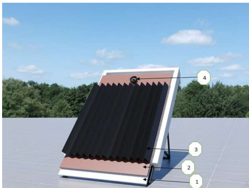
4-rasm. Uchburchak kanalli quyoshli havo isitgichining sxemasi. 1,2- izolyatsion qatlam, 3-qoraytirilgan yuza, 4- so'ruvchi vintelyator.
