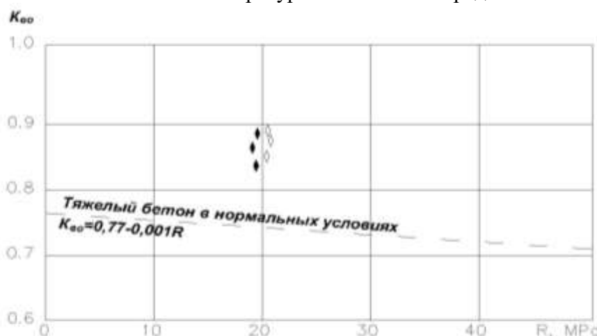
Рис.1 Коэффициент призмной прочности бетона в условиях сухого жаркого климата. --- под солнечной радиацией.
