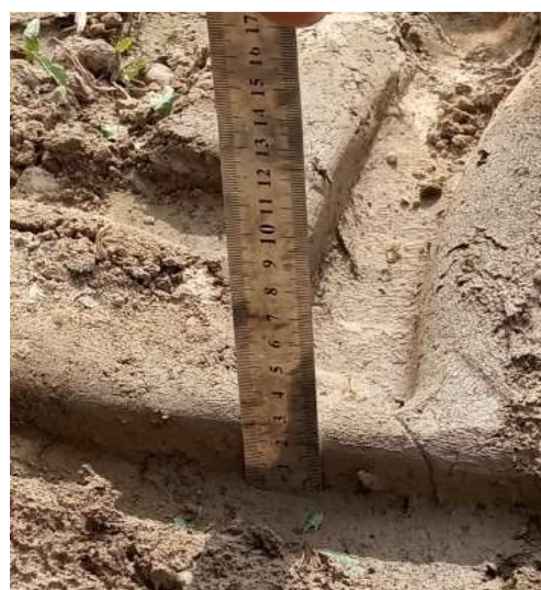
3-расм. Ғилдирак шинасининг тупроқда қолдирган изи баландлиги а) шина қолдирган изи чуқурлиги; б) из чуқурлигини ўлчаш.
