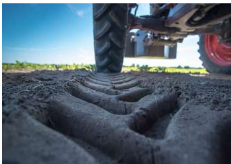
3-расм. Ғилдирак шинасининг тупроқда қолдирган изи баландлиги а) шина қолдирган изи чуқурлиги; б) из чуқурлигини ўлчаш.
