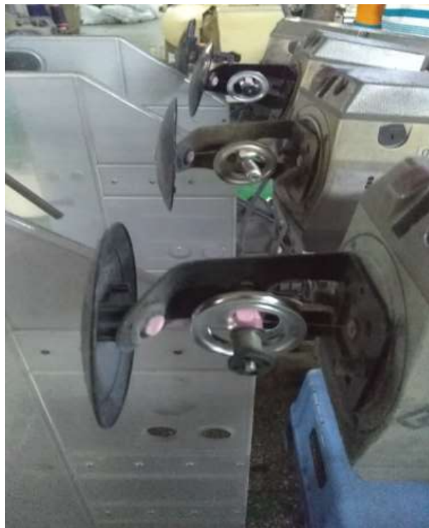
4-расм.SMIT эгилувчан рапиралик тўқув дастгоҳига ўрнатилган арқоқ ипида ҳосил бўлаётган балон сўндиргичи.
