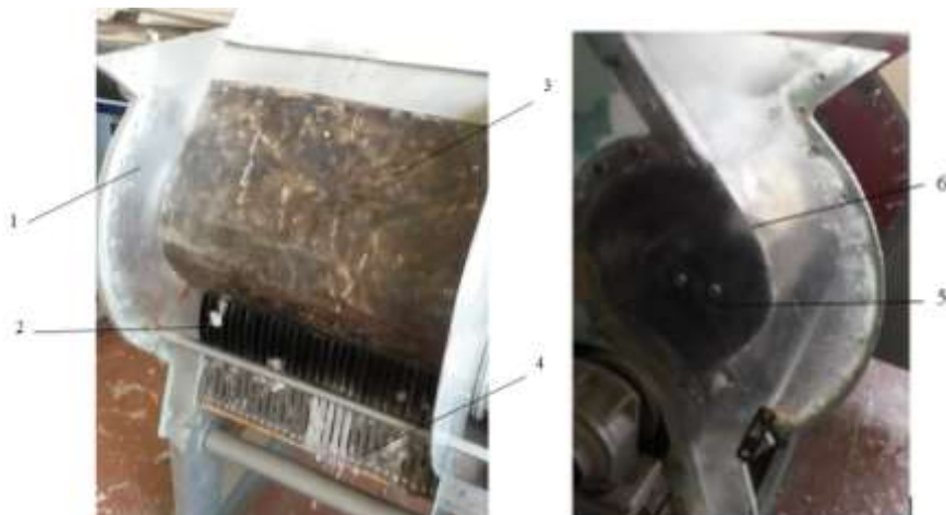
3-расм. Янги ишчи камерага метал листни ўрнатиш жараёни. 1-ён девор ўрнида ўрнатилган оргшиша, 2-аррали цилиндр, 3-метал лист, 4-колосникли панжара, 5-ишчи камера, 6-ўрнатилган метал лист.
