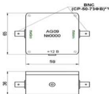
4-rasm. AG09 oraliq o'tkazuvchini tashqi ko'rinishi.
