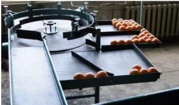
5-расм. Дискли саралаш машинаси.
