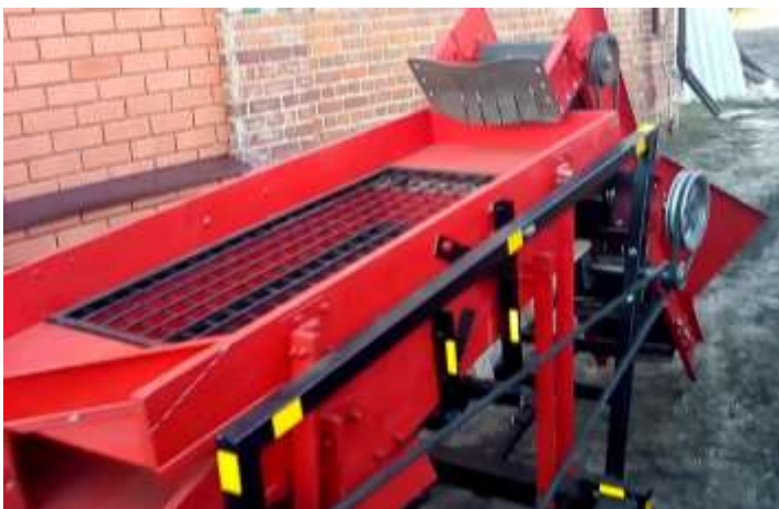
2-расм. Элакли саралаш машинаси.
