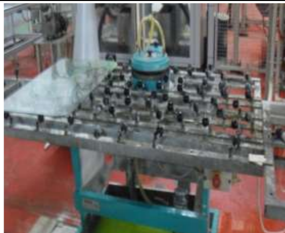
2-rasm. Abraziv disk o'rnatish kallagining umumiy ko'rinishi.
