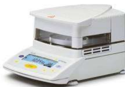
4-5-rasmlar. Gruntning tabiiy namligini aniqlash jarayoni.
