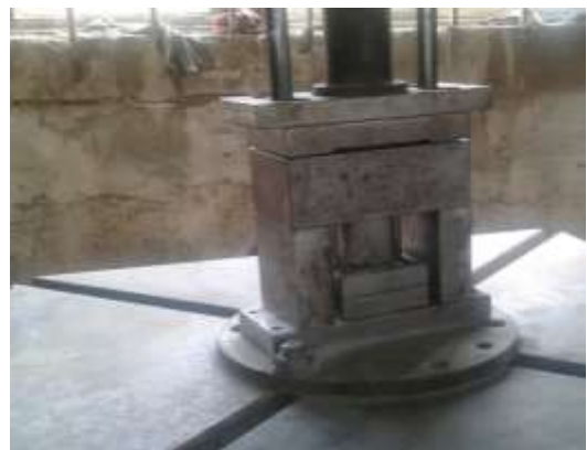
1-расм. Штампнинг пресс дастгоҳига ўрнатилган ҳолати.
