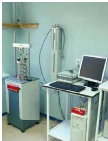
6-7-rasmlar. Gruntning deformatsiya ko'rsatkichini kompressiya usulida aniqlash uchun stabilometr uskunasining ko'rinishi.
