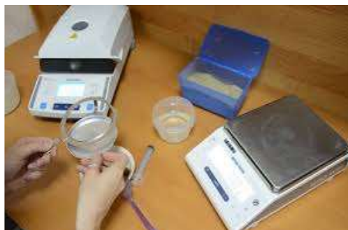
4-5-rasmlar. Gruntning tabiiy namligini aniqlash jarayoni.
