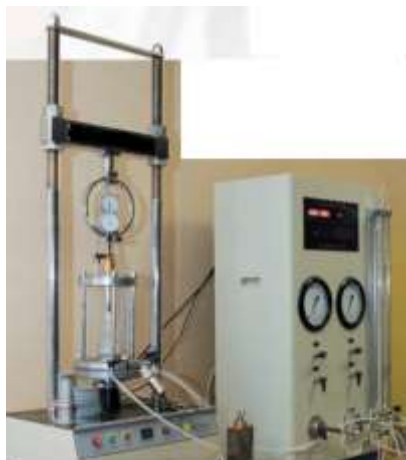
6-7-rasmlar. Gruntning deformatsiya ko'rsatkichini kompressiya usulida aniqlash uchun stabilometr uskunasining ko'rinishi.
