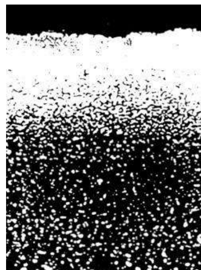
Рис.1 – Микроструктура диффузионного слоя стали 40, нитроцементованной при температуре 650 0 С в течение 2-х часов (×500).
