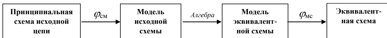
Рис.1. Блок-схема процедуры эквивалентного преобразования.
