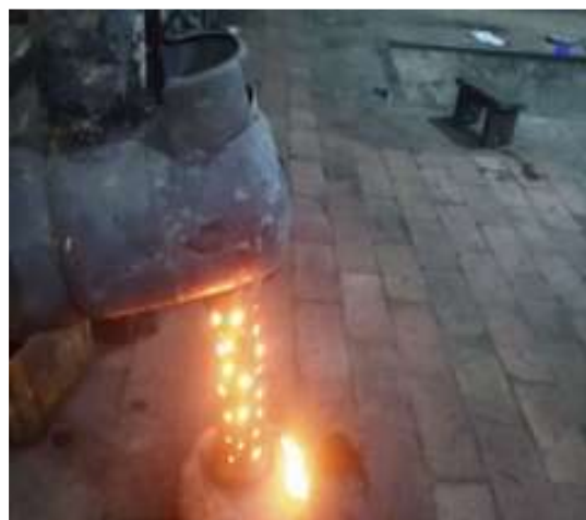
3-rasm. Ishlatilib bo'lingan transformator moyini yoqish orqali issiqlik energiyasiga aylantirish
