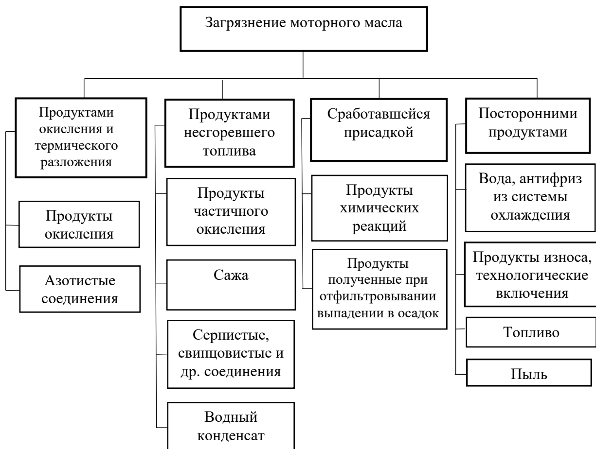
Рис. 1.2. Схема процесса старения моторного масла
