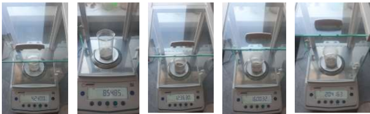
3-расм. Чанг наъмуналарини оғирдигини аниқлаш усули.
