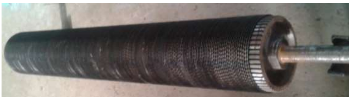
3-rasm. Kolosniksiz linteri uchun yig'ilgan arrali silindr sxemasi.
