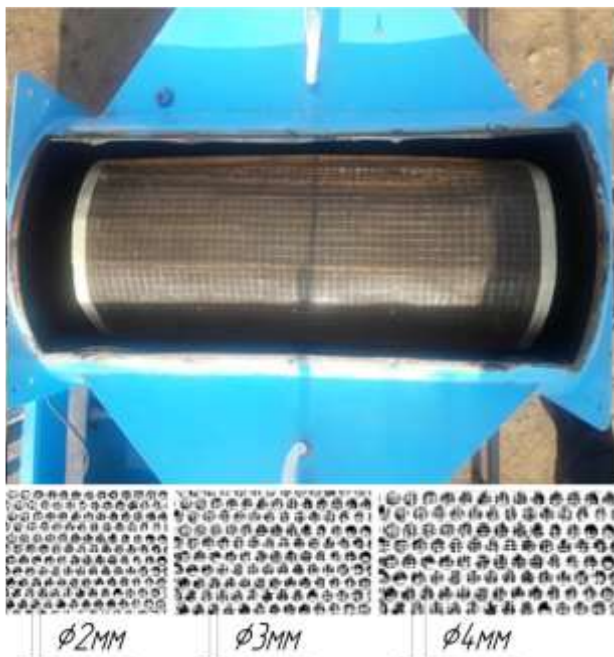
4-расм. Роторга қoplanган фiльтрловчи тўрли материалнинг кўриниши.
