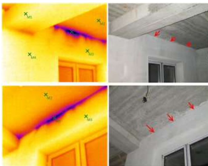
1-rasm. Kvartirada issiqlik yo‘qotishlarini teplovizor eordamida o‘rganish natijalari
