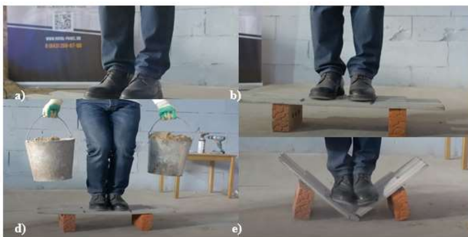
1-rasm. Betonaplitalarni egilishga bo‘lgan mustaxkamligini tekshirish.
