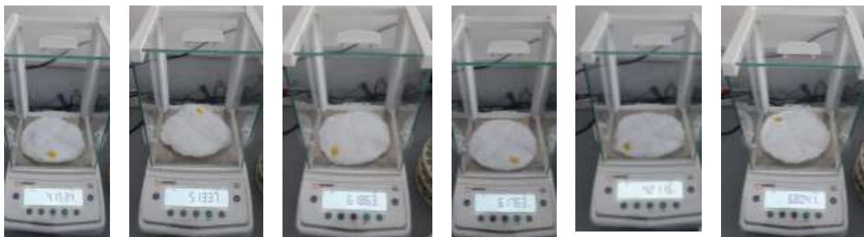
5-расм. Фильтрларни оғирлигини аниқлаш усули
