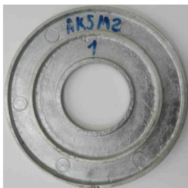
Рис. 1. Междупильная прокладка линтерных машин.
