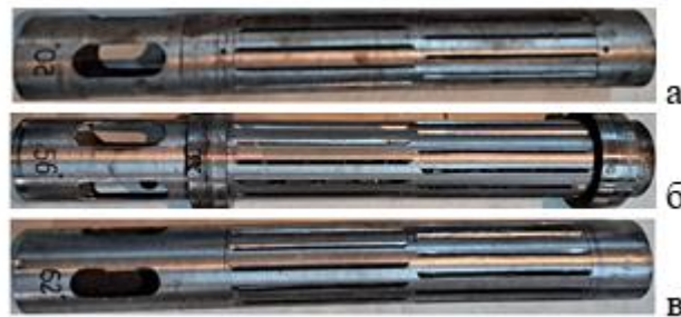
Рис. 4. Трубы с различными углами ( а – 50°; б – 56°; в – 62°) перфорации
