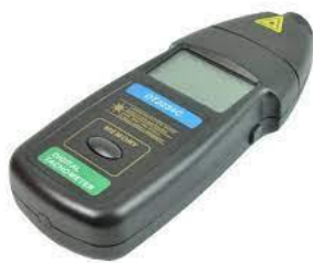
5- rasm. Tikuv jihozining tezligini Raqamli taxomet DT2234B o'lchov jihozi.
