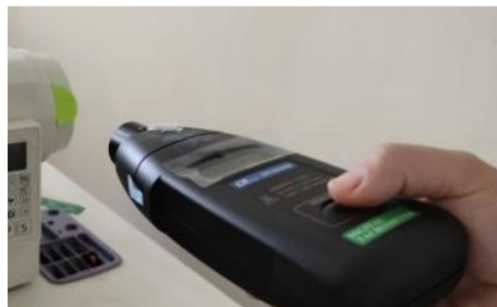
5- rasm. Tikuv jihozining tezligini Raqamli taxomet DT2234B o'lchov jihozi.
