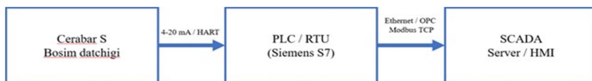
1-rasm. Qurilmaning SCADA tizimi bilan ulanish.
