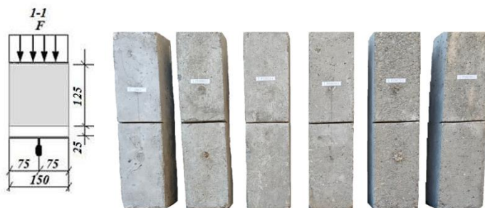
4-rasm. po'lat va bazalt tolalari qo'shilgan beton- prizma namunalari.
