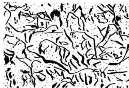
1 – rasm. Kulrang cho'yanning optik mikroskopida olingan mikrostruktura tasviri.
