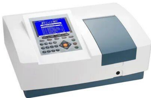
a- UV-Vis спектрофотометр
