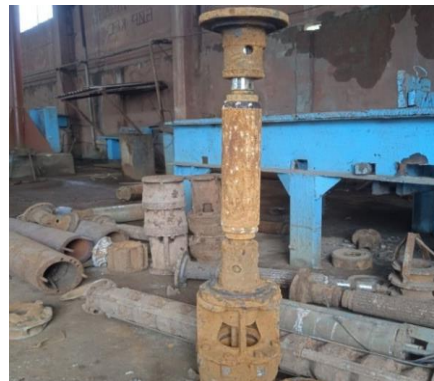
1-rasm. ESV 10–160–35 tik quduq nasosining metall konstruksiyasi korroziyaga uchragan holati.
