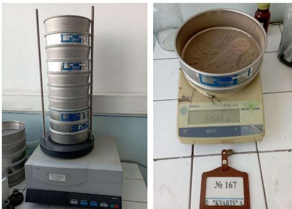
3-rasm. RETSCH-DIN-ISO 3310/1 markali saralovchi elak laboratoriya qurilmasi.
