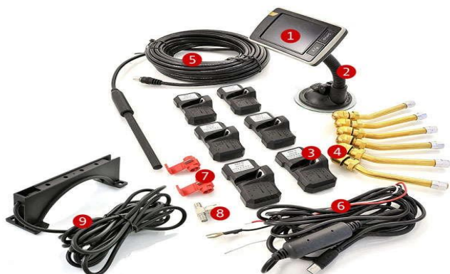
1-rasm. Carax TPMS CRX-1061 ichki bosim sezgichlari asosida shinalar bosimini nazorat qilish to'plami. 1 - qabul qilish bloki; 2 - assimilyatsiya chashka bilan o'rnatiladigan braket; 3 - ichki bosim sezgichlari; 4 - vanalar; 5 - antenna; 6 - quvvat adapteri; 7 - yordamchi qurilmalar, 8 - antenna simi ajratuvchisi; 9 - qavsli antenna.
