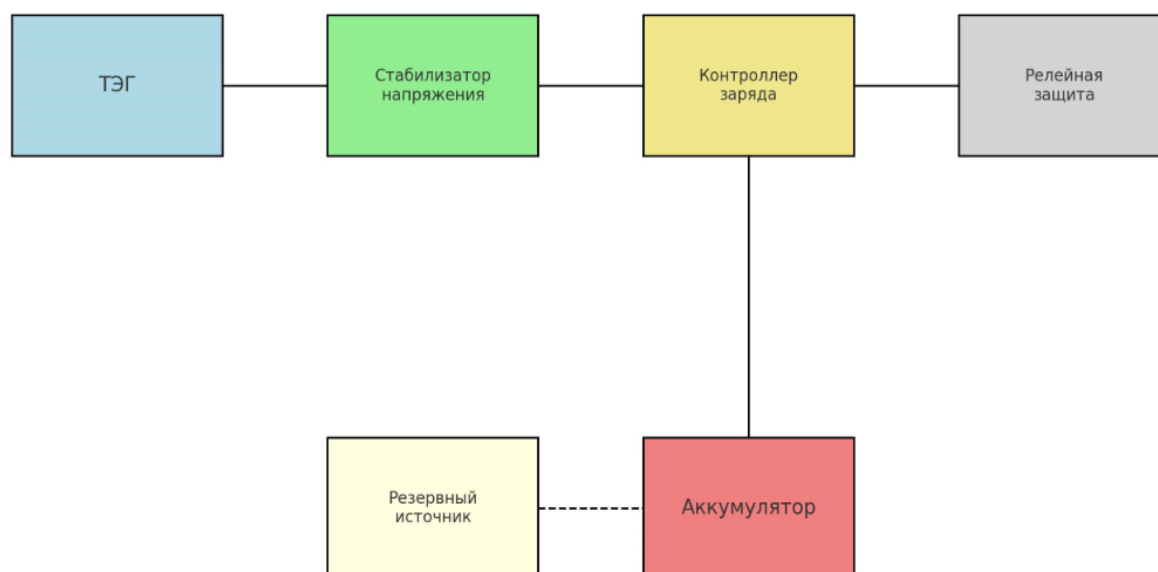
Рис.1. Принципиальная блок-схема подключения ТЭГ к системе релейной защиты.
