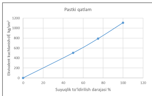
4a-rasm. Pastki qatlamdagi ekvivalent kuchlanishning suyuqlik to'ldirish darajasiga bog'liqligi diagrammasi
