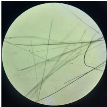
4-Расм. Базальт толанинг микроскопда 100 марта катталаштирилган кўриниши.
