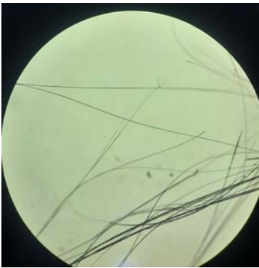
4-Расм. Базальт толанинг микроскопда 100 марта катталаштирилган кўриниши.
