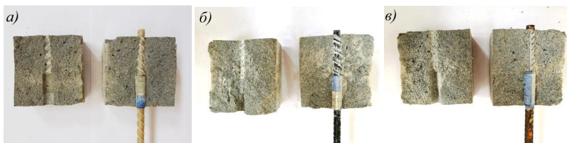
2-rasm - Armaturaning g'ovak beton bilan ilashishining buzilish xususiyati: a) shisha kompozit; b) bazalt kompozit; v) metal.
