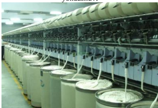
3-rasm. Rotor (ochiq uchli) yigirish texnologiyasi
