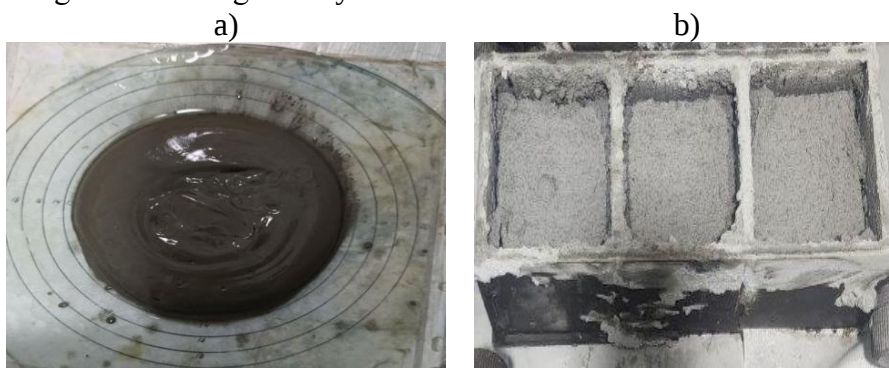
a – kimyoviy qo'shimcha qo'shilgan ko'pikkulbeton namunasining yoyiluvchanlik jarayoni; b – ko'pikkulbeton namunasining quygandan keyingi holati. 3-rasm. A1 ko'pikkulbeton kimyoviy qo'shimcha qo'shilgan namunasi.
