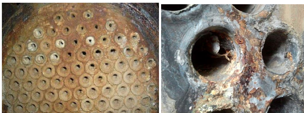
2-rasm. Issiqlik almashinish jarayonida quvurlarda cho‘kmaning hosil bo‘lishi.
