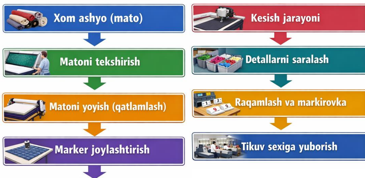
1-rasm. Tayyorlov sexidagi kesish jarayoni sxemasi.
