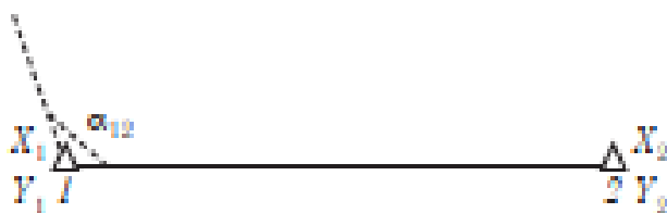
1.3-shakl. 1 va 2 punktlar orasidagi yo'nalish uchun direksion burchakni o'lchash.
