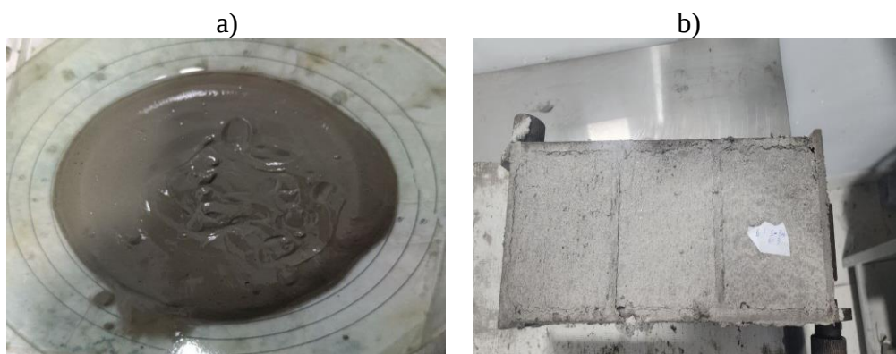
a – kimyoviy qo'shimcha qo'shilgan ko'pikkulbeton namunasining yoyiluvchanlik jarayoni; b – ko'pikkulbeton namunasining quygandan keyingi holati. 4-rasm. A3 ko'pikkulbeton kimyoviy qo'shimcha qo'shilgan namunasi.
