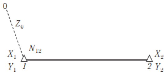
1.4-shakl. 1 punktga 2 punktga yo‘nalishni o‘lchash holati.
