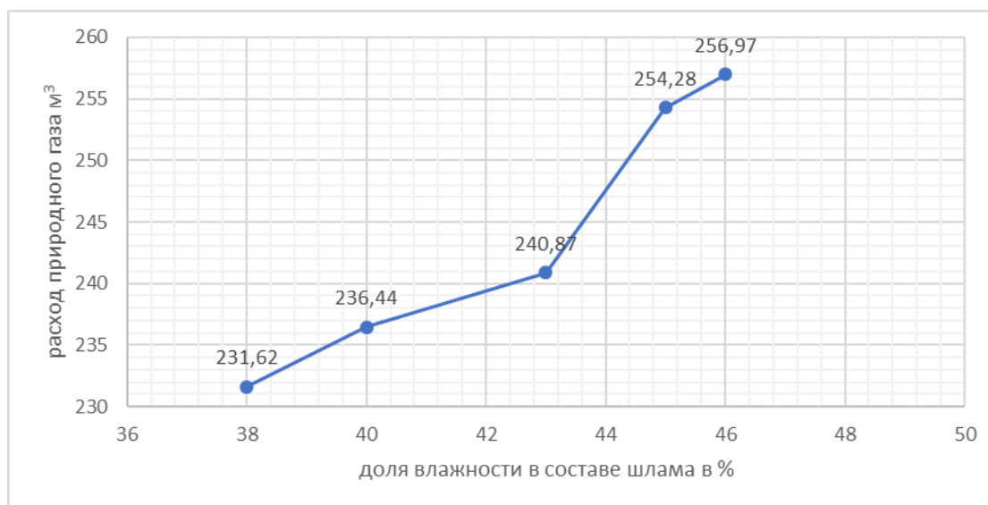
Рис. 3. Зависимость расхода природного газа при обжиге клинкера от содержания влаги в составе шлама.
