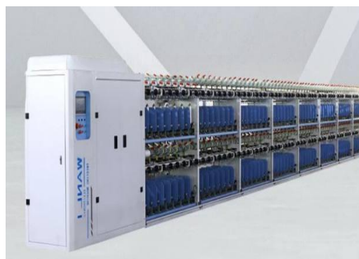
4-rasm. Air-Jet (havo reaktiv) yigirish texnologiyasi.
