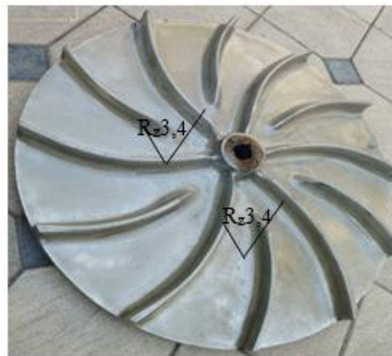
5-rasm. Termoreaktiv kompozit polimer material surtilgan parrak.
