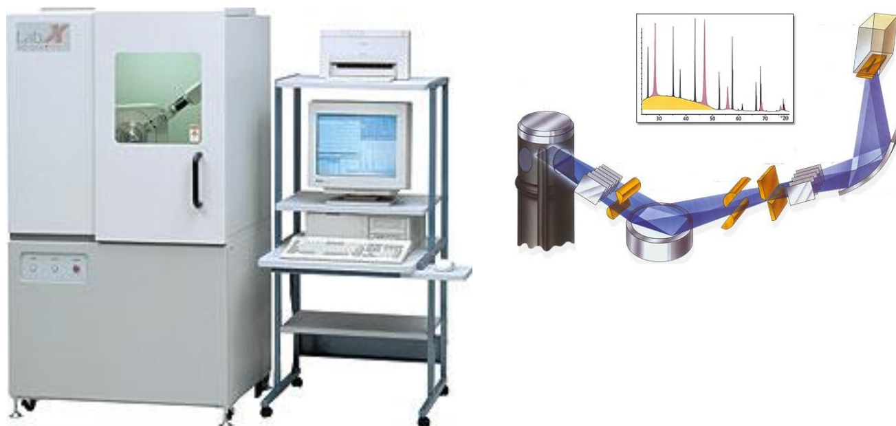
1-rasm. Rengenografik difraksion tadqiqotlari XRD-6100 (Shimadzu, Yaponiya) va uning ishlash sxemasi
