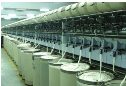
3-rasm. Rotor (ochiq uchli) yigirish texnologiyasi.
