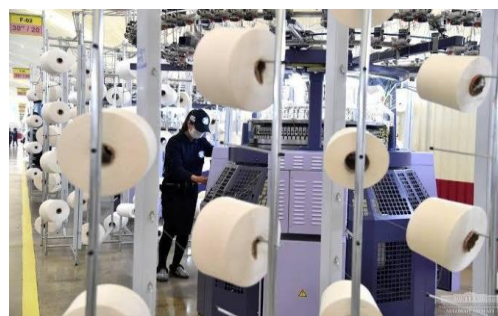
6-rasm. Trokotaj tuqish jarayoni.
