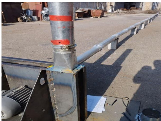
2-rasm. 26 m quvurlar tizimiga ega bo'lgan pnevmotransport
