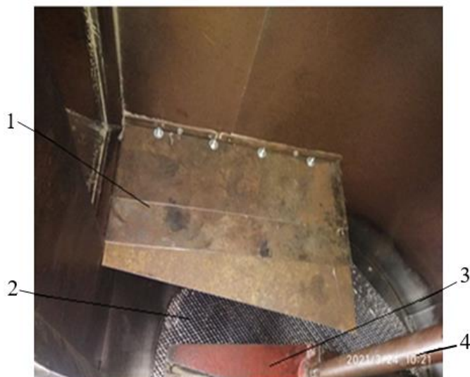
2-rasm. Tarpetsiya shakldagi yo'naltirgich o'rnatilgan separator ishchi kamerasi. 1- trapeziya shakilda yo'naltirgich; 2-to'rtli yuza; 3-sidirgich, 4-sidirgich vali.
