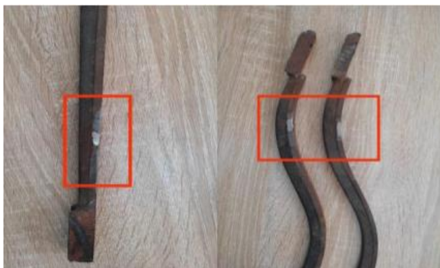
2-rasm. Eritib qoplangan jin kolosniklari.
