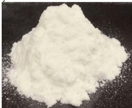
Рис.4. Микрофотография общего вида МКЦ из камышовой целлюлозы.
