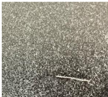
Рис.5. Микрофотография частиц МКЦ из камышовой целлюлозы (диаметр проволоки 0,3мм).
