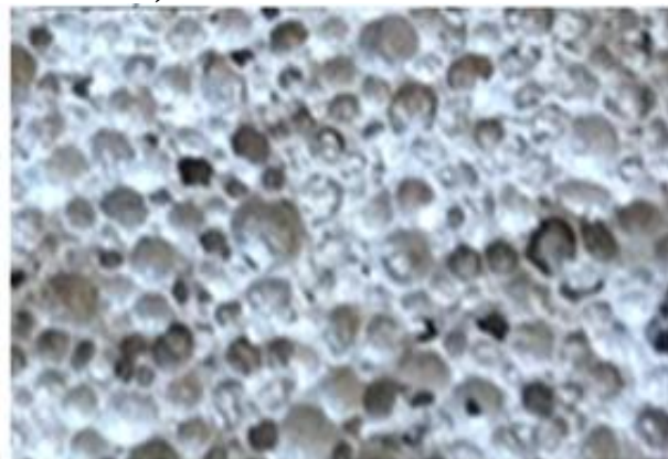
3-rasm. Gipsli kompozitsion materiallari namunasining elektron mikroskopik tasvirlari.
