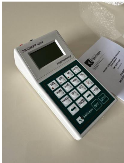
Рисунок 2.1 - Внешний вид прибора "Эксперт-004".
