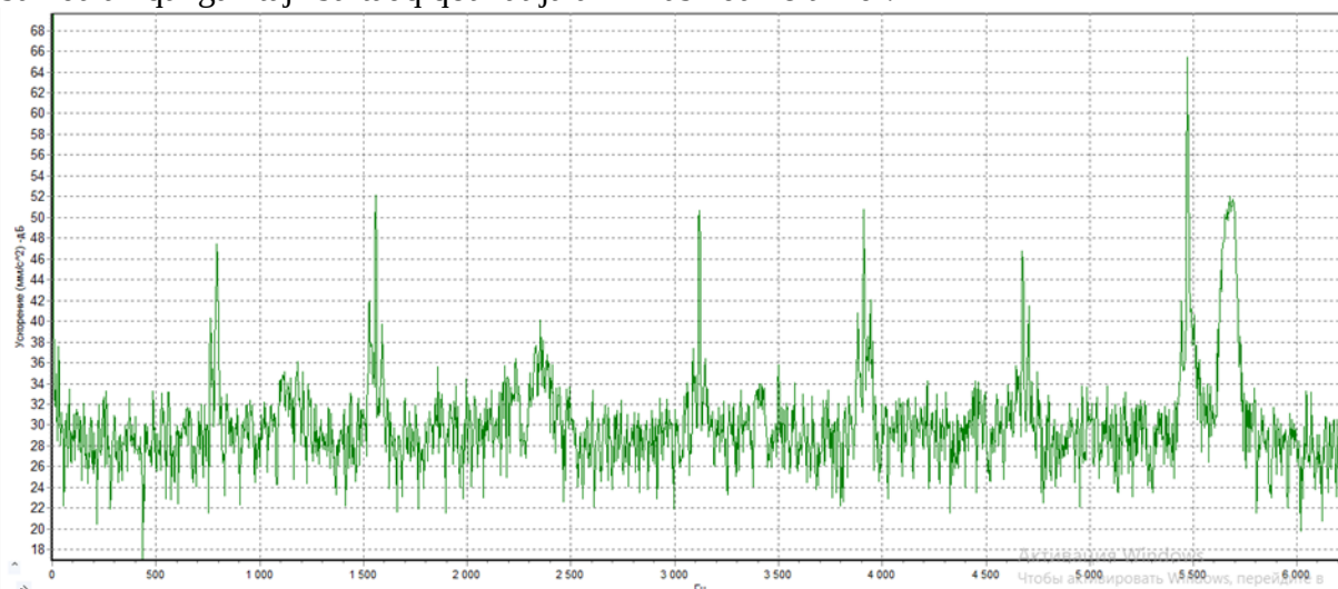
2-rasm. TM3 630/10/0,4-82Y1. Moyli kuch transformatori bakining yuqori kuchlanish tomoni quyi qismining vibroakustik parametrlari.
