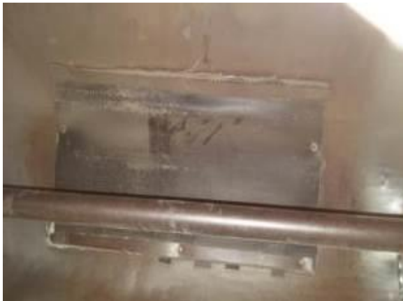
5-расм. Ишчи камера орқа деворига ўрнатилган амортизаторли пластина қурилмасининг кўриниши.
