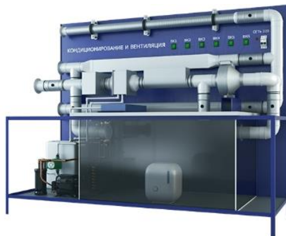
1-rasm. PAXP-VV-K "Ventilyatsiya tizimini sinash" laboratoriya stendi.
