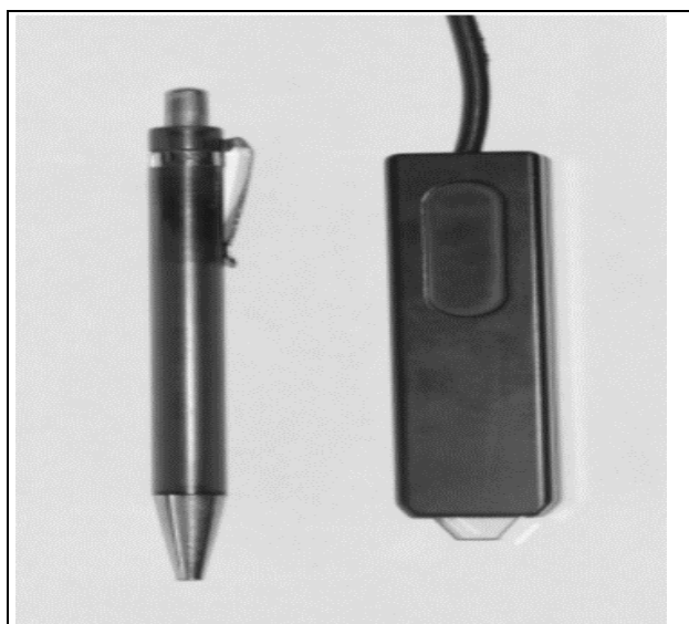
Рис. 2. Восьмиканальная тензометрическая станция с поляризационно -оптическими датчиками напряжений различных конструкций
