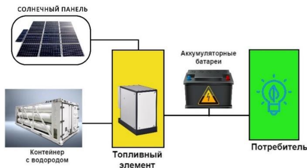
Рисунок 2 – Гибридная система аккумулялирования энергии.
