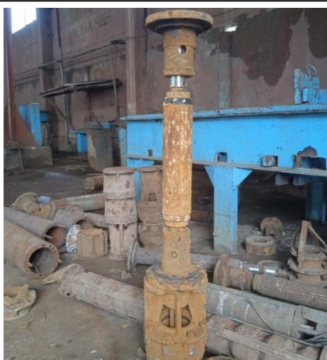
2-rasm. ESV 10–160–35 tik quduq nasosining metall konstruksiyasi korroziyaga uchragan holati.
