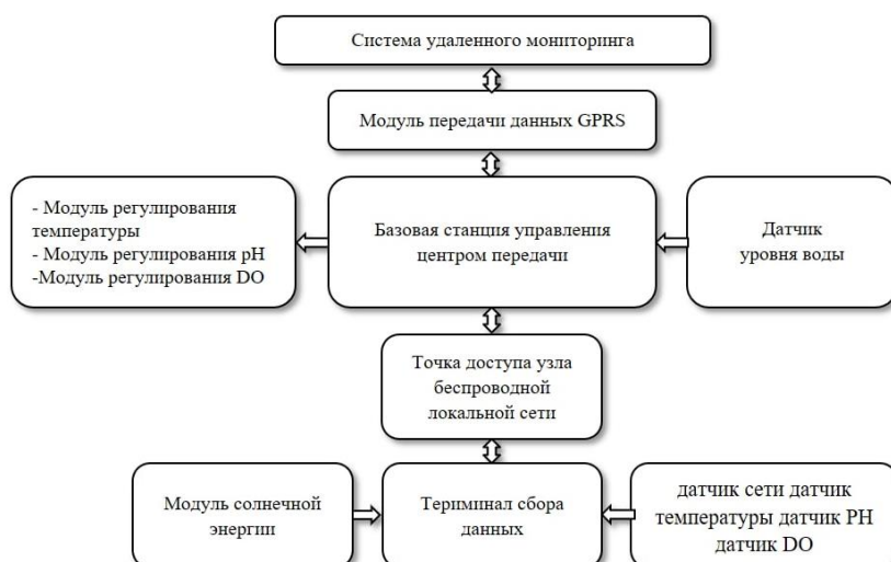
Рис.1. Структурная схема системы беспроводного мониторинга качества воды.
