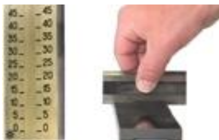
1-rasm. Bo'yoq va lak materiallarini silliqdash darajasini aniqlash uchun o'lchov plitasi va qirg'ich
