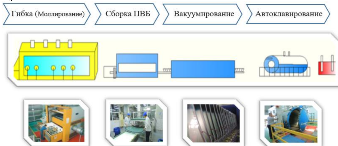
2-rasm. Old oynalarini tayyorlash texnologik jarayoni
