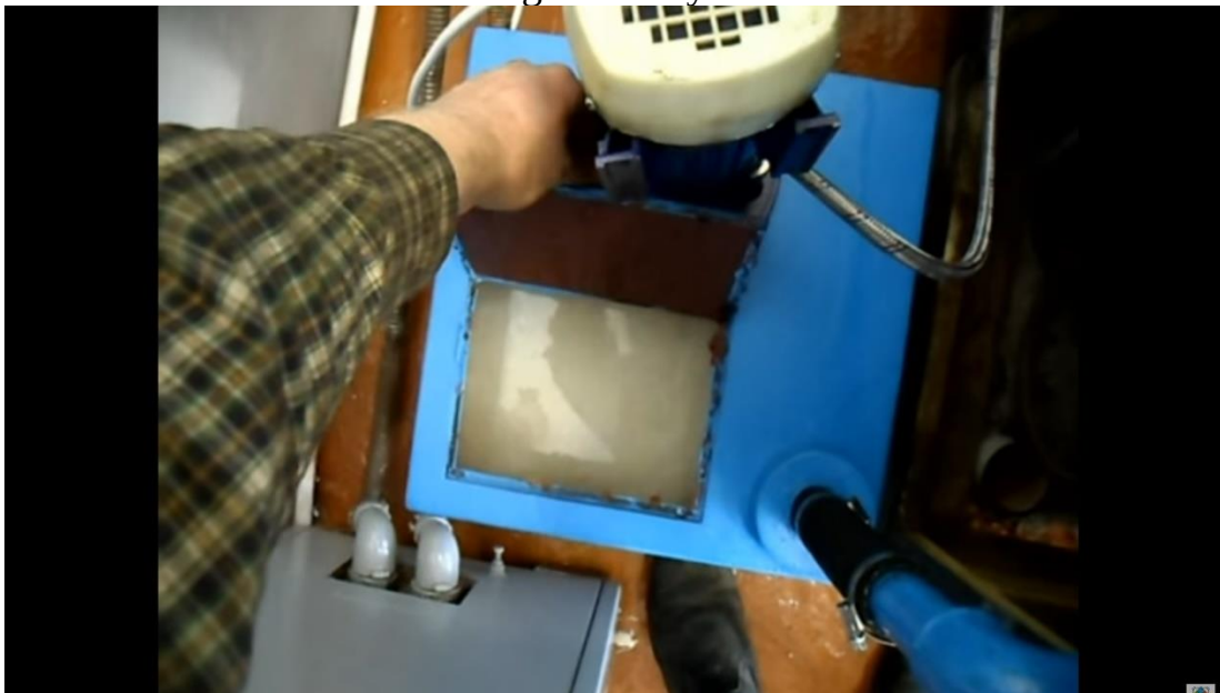
2-rasm. Metall qirqish dastgohlarida moylash-sovitish suyuqliklarining joylashish qutisi
