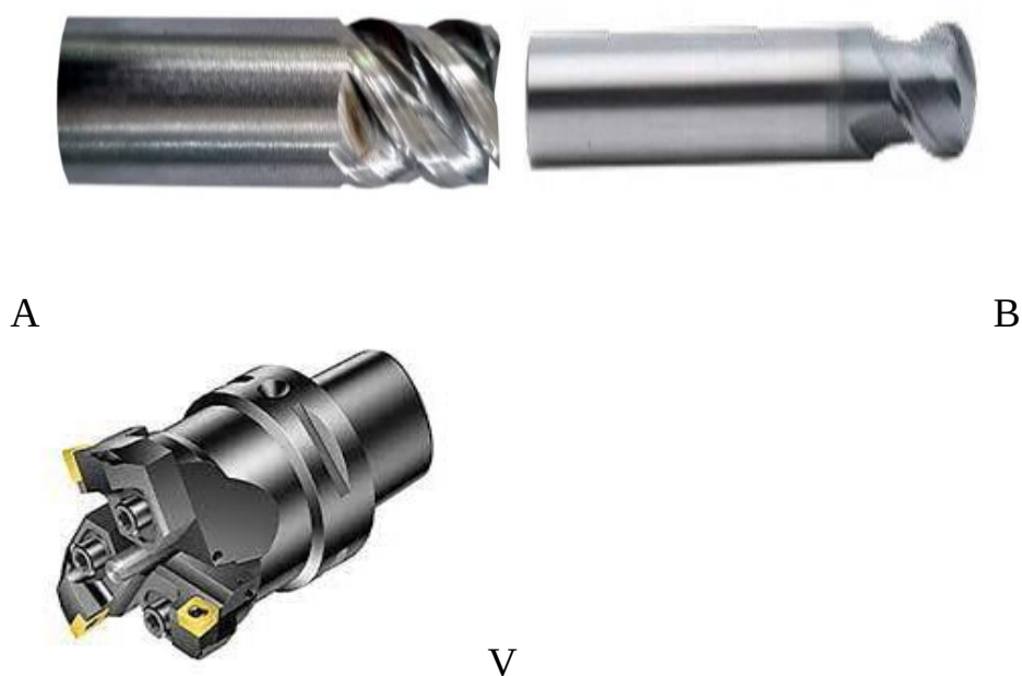
2-rasm. Qattiq qotishmali frezaning konstruksiyalari
