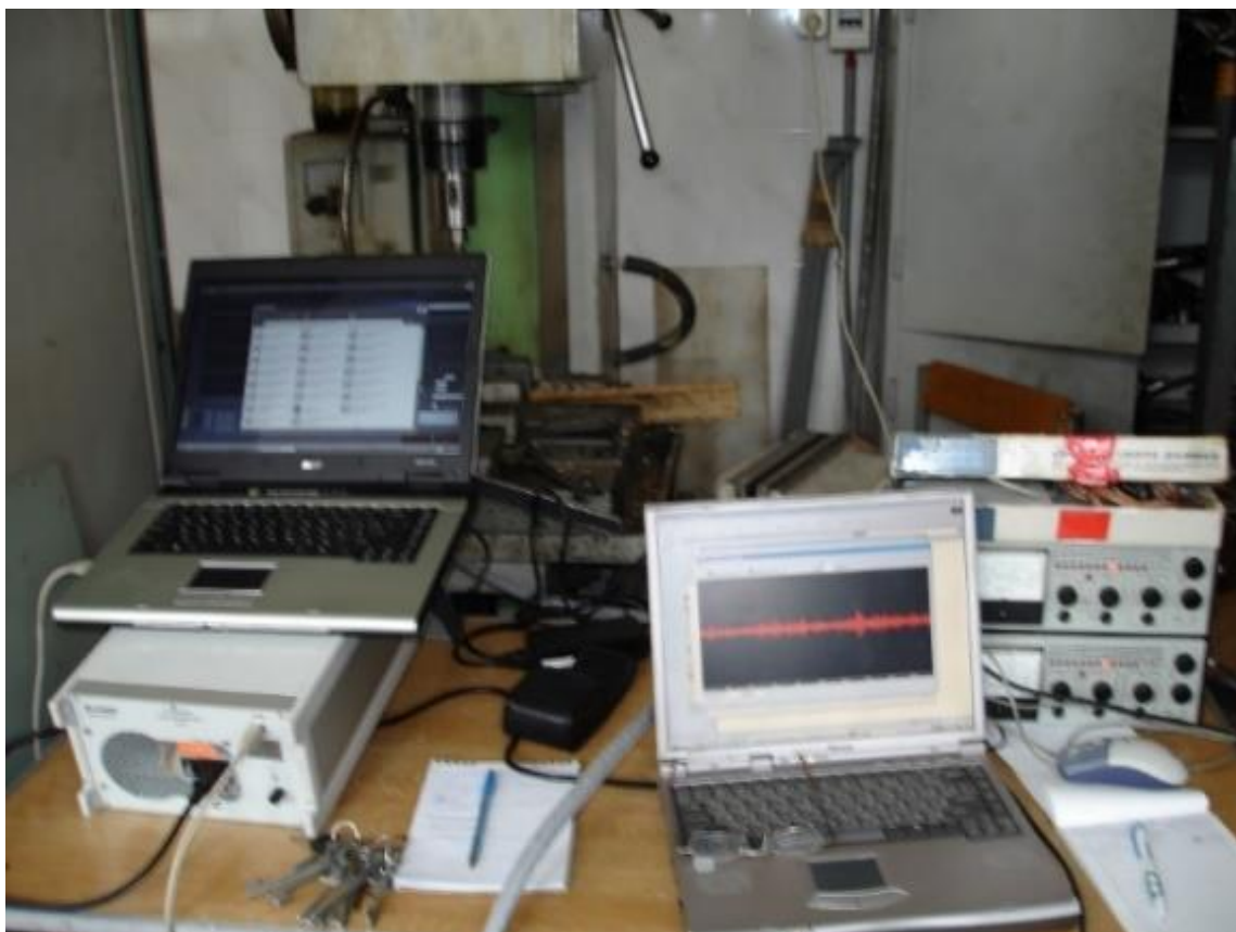
1-rasm. 2A135 dastgohiga asoslangan vibroakustik signali barqarorligini tahlil qilish stendining umumiy ko‘rinishi:
