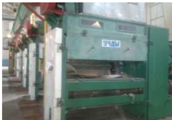
4-расм. Комбинацияланган арра-металл чўткали цилиндрнинг уруғлик чигит делинтерлаш машинасига ўрнатилиш ҳолати.
