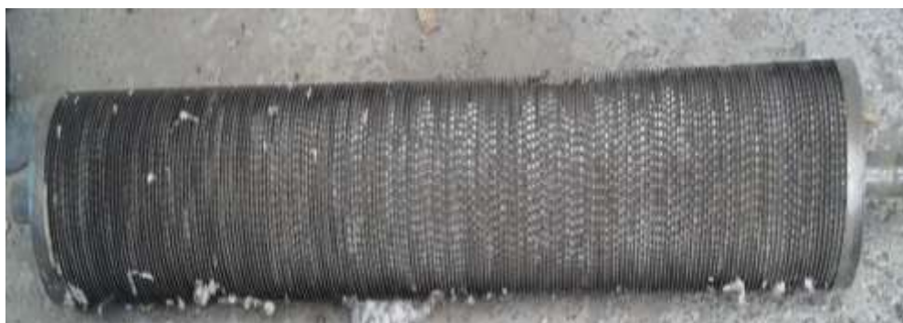
2-расм. УЧДМ русумли уруғлик чигит делинтерлаш машинасининг аррали цилиндрининг умумий кўриниши.
