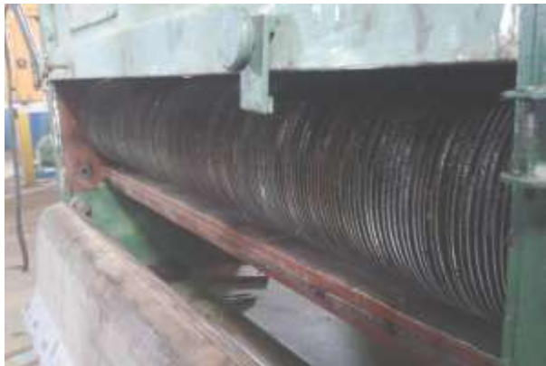
4-расм. Комбинацияланган арра-металл чўткали цилиндрнинг уруғлик чигит делинтерлаш машинасига ўрнатилиш ҳолати.
