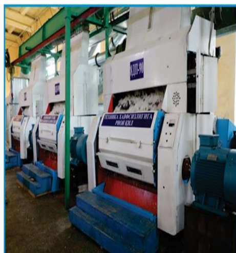
2-rasm. «Murrey-80»rusumli arrali jin mashinasi va ishchi kamerasi.
