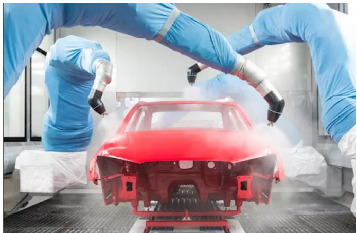
1-rasm. Yengil avtomobil kuzovlarini maxsus xonada robotlar yordamida bo'yash jarayoni [6].
