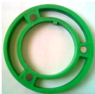
3-rasm. AQSH, Xitoy va Hindiston firmalarining arralararo kistirmalari.
