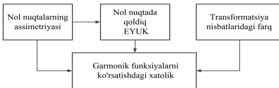
2-rasm. Sinus-kosinusli aylanuvchi transformatorlar yordamida burchakni o'lchashdagi asosiy xatolar o'rtasidagi munosabatlarning tuzilishi.
