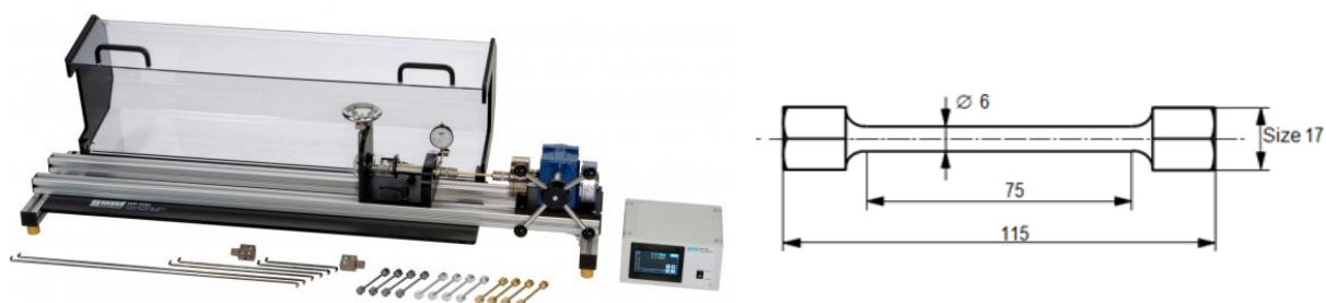
Рисунок 3. WP 500, 30Нм испытательная оборудование и размер образца.
