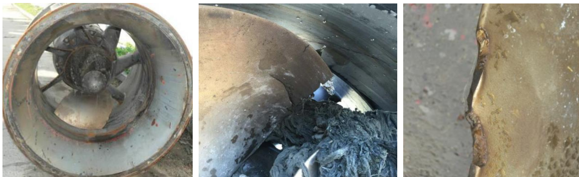
Рис.3 - Повреждения лопастей РК на задней и передней кромке.
