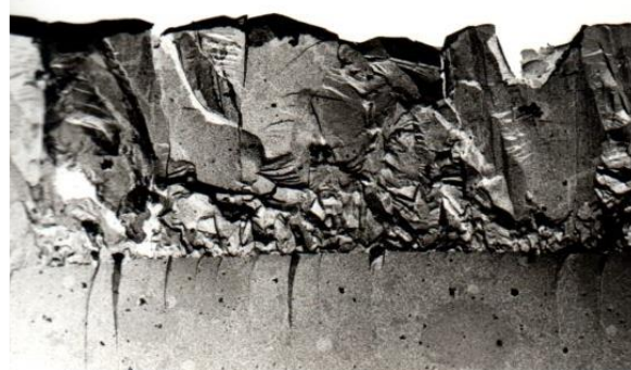
Рис. 5. Фракто-грамма поперечного излома пленки CdSe, полученной при T_n=250^\circ\text{C} . (x7500).
