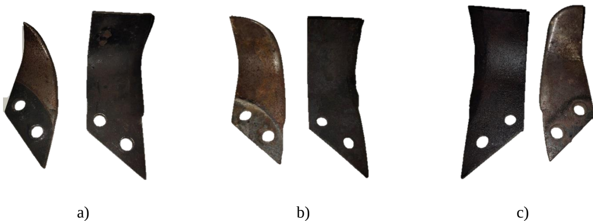
a) D-markali po'latdan tayyorlangan Turkiya davlatida ishlab chiqarilgan freza b) Mavjud mahaliy hom ashyolardan prokatlab tayyorlangan freza (Cr-D) c) Mavjud mahaliy hom ashyolardan prokatlab tayyorlangan freza (Cr-50) 1-rasm. Do'nder kultivatorning Г-simon freza pichoqlarning yeyilish darajasi
