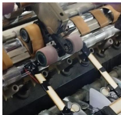
1б-расм. Чўзиш майдонига ўрнатилган тензодатчик
